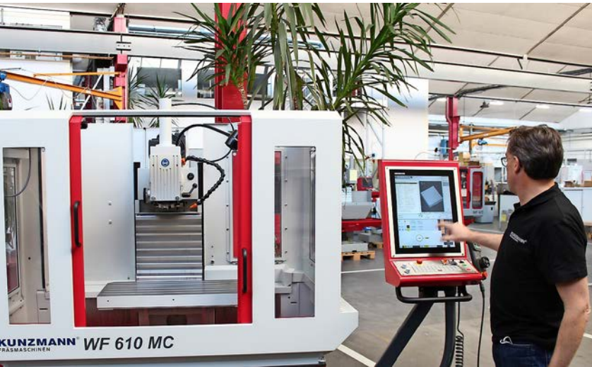
Karsten Feil demonstriert die flexible Hybridlösung WF 610 MC, die wahlweise manuell oder im CNC-Betrieb eingesetzt werden kann.
