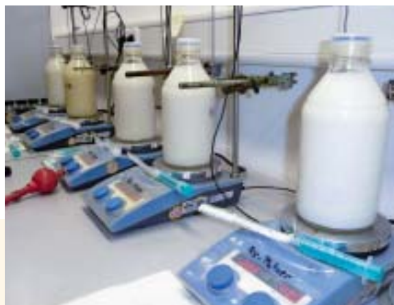
Impfzyklentests simulieren im Labor die Keimbelastung von Kühlschmierstoffen. Diese Tests sind Voraussetzung für die Entwicklung stabiler Formulierungen
